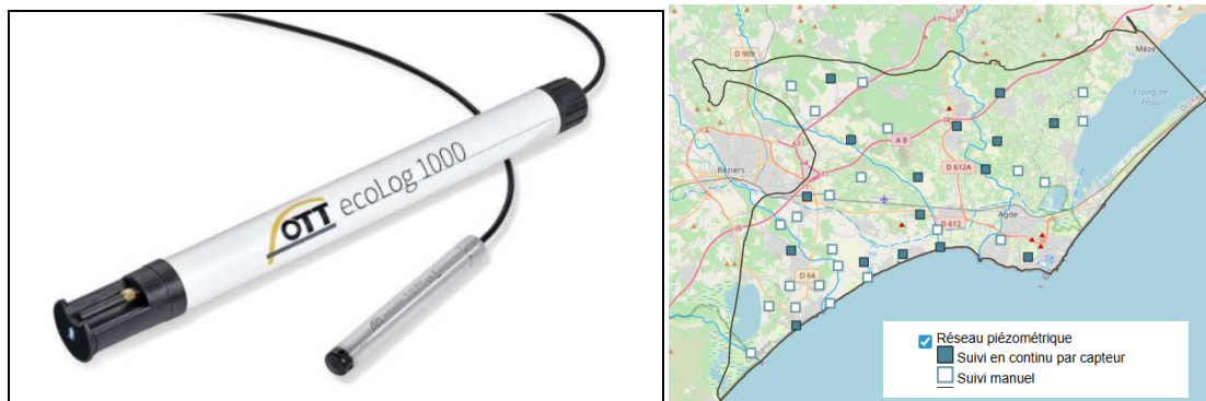
Figure 10 : ECOLOG 1000 d'OTT équipant le réseau de surveillance piézométrique en continue de la nappe astienne
