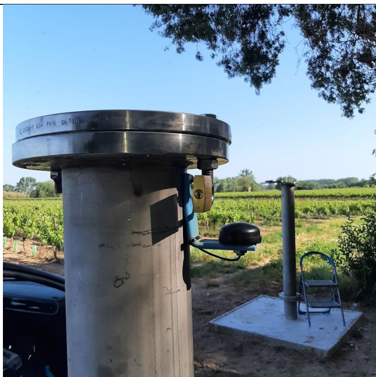
Piézomètre doublet – tête de piézomètre avec sonde piézométrique de mesures continues avec télétransmission des données
