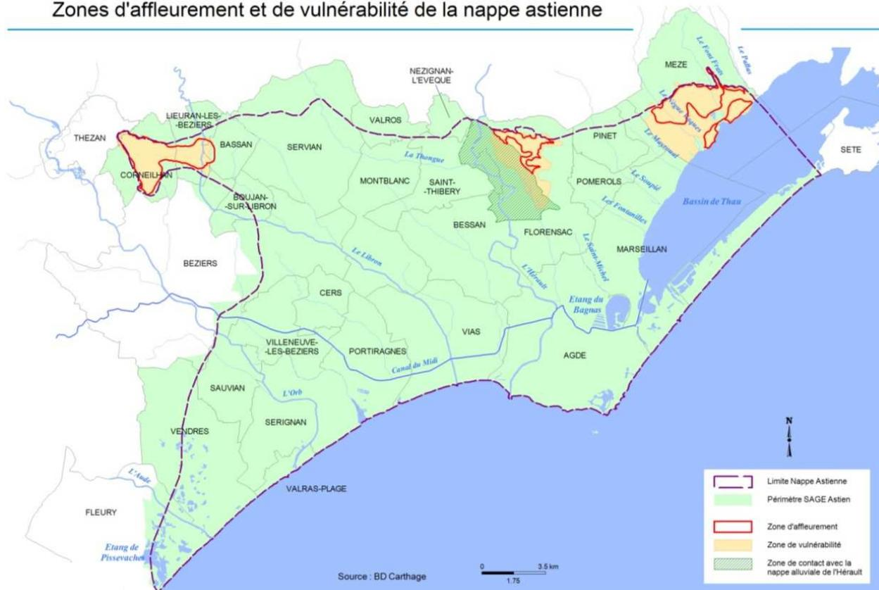
Figure 2 : Zones d'affleurement et de vulnérabilité de la nappe astienne
