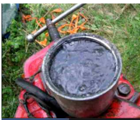
Figure 22 : Remontée d'eau saline profonde avec dégazage sur un piézomètre - Agde
